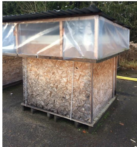
Figur 3. Fotografi på en av kuberna med utvändigt cellplast isolering (vänster). För att skydda det yttre skiktet från fukt och ev. skadegörelse har samtliga kubertäcks in med USB skivor (höger).
