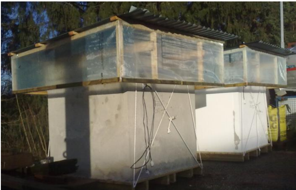
Figur 1. Två av de tillverkade miniatyrhusen, till vänster betong utvändigt och till höger betong invändigt.
