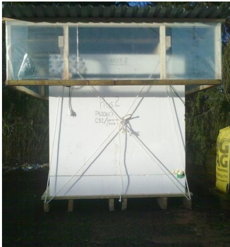
Figur 3. Fotografi på en av kuberna med utvändigt cellplast isolering (vänster). För att skydda det yttre skiktet från fukt och ev. skadegörelse har samtliga kubertäcks in med USB skivor (höger).
